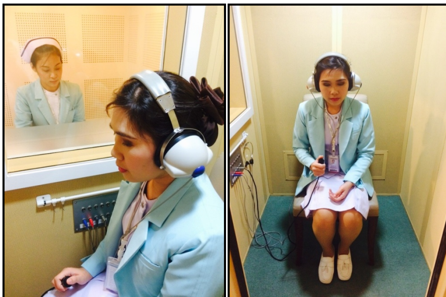
ภาพที่ 27 การทำ Functional check เป็นสิ่งที่ผู้ตรวจการได้ยินจะต้องทำเป็นประจำทุกวัน เพื่อจะได้ทราบว่าเครื่องตรวจการได้ยินมีความผิดปกติใดๆ เกิดขึ้นหรือไม่
